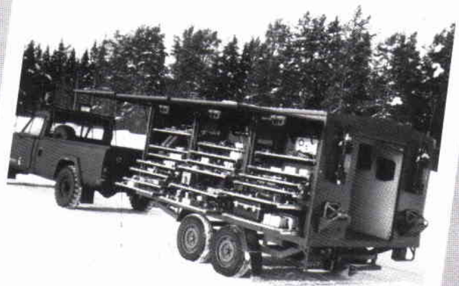
Reparationskärra för fältmässig flygplanreparation
