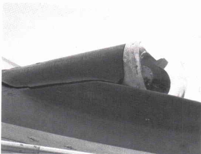
IR/Laser utrustning placerad på MiG-29 nosovansida.
