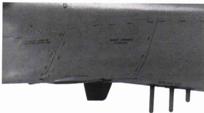
Antennförstärkning under MiG-29 nos bl a IK-antenn.
