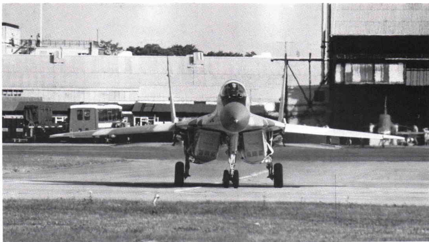
På MiG-29 stängs luftintagen vid taxning, start och landning som skydd mot FOD.
