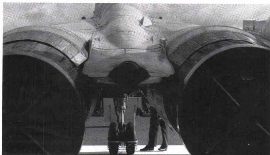
Luftbroms och behållare för bromsskärm mellan motorutloppen på MiG-29.
